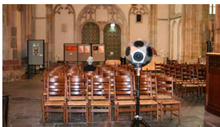
* Op de voorgrond: omnidirectionele geluidbron (dodecahedron); op de achtergrond: Head and Torso Simulator, beide instrumenten van Brüel & Kjaer (foto Frans Luteijn).
